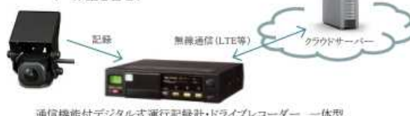
通信機能付デジタル式運行記録計・ドライブレコーダー 一体型
