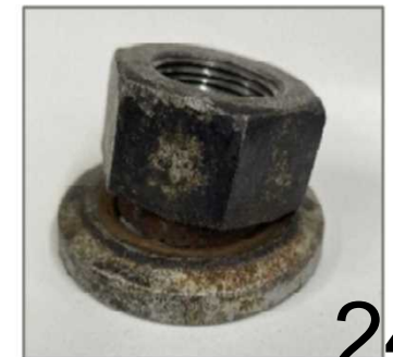
劣化したホイール・ナット
