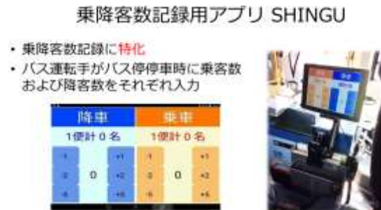
図 乗務員がタッチパネルを操作することにより乗降客数を簡易に計数できる車載アプリ
