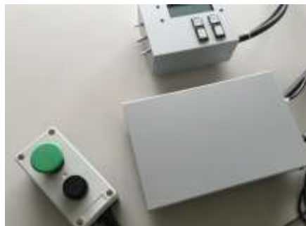
図 乗務員がボタンを押下することで簡易に乗降客数を簡易に計数できる車載アプリ
