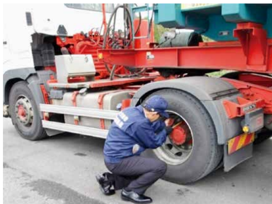
車輪脱落防止のための検査
