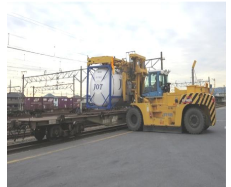
【ISO タンクコンテナ荷役作業】
