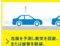
車載のレーダーやカメラにより前方の車両や歩行者を検知し、衝突の可能性がある場合には、運転者に対して警報します。さらに衝突の可能性が高い場合には、自動でブレーキを作動します。
