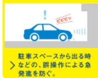
停止時や低速走行時に、車載のレーダー、カメラ、ソナーが前方や後方の壁や車両を検知している状態でアクセルを踏み込んだ場合には、エンジン出力を抑える等により、急加速を防止します。
