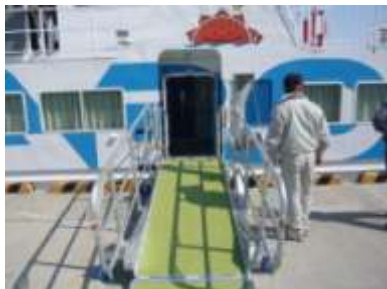
船内出入口のスロープ
