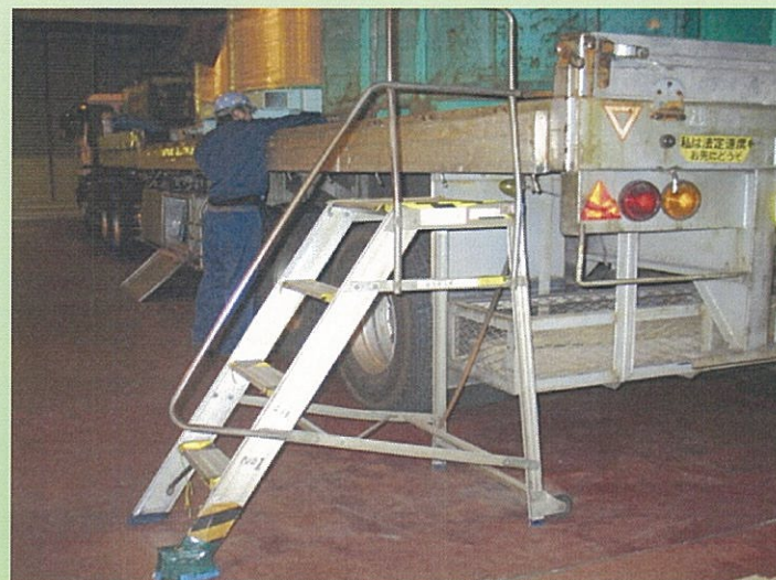
荷台への昇降設備の例 (陸上貨物運送事業者側で用意する場合であつても、荷主先等で保管場所の確保が必要)
