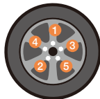
仮止めの順番(5穴)
