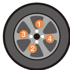
仮止めの順番(4穴)
