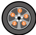
仮止めの順番(5穴)
