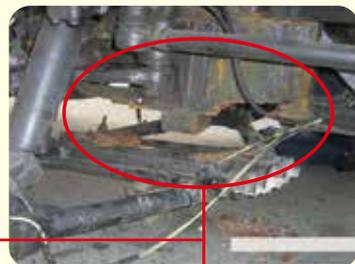
主要骨格部位の腐食による穴あき等は、堅ろうではないとして保安基準不適合
