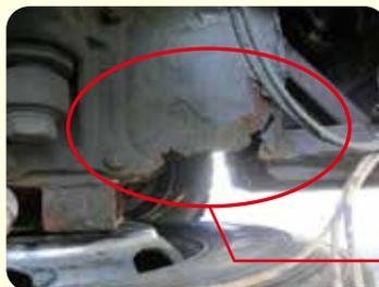
この事故は、凍結防止剤によるフレームの腐食のためローアームがフレームから脱落し、ハンドル操作が不能となったことが原因と考えられる。打音点検(下記参照)等、適切な点検整備の実施による確認が必要。
