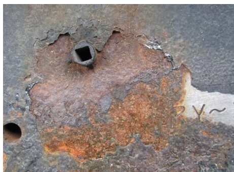
腐食し識別困難となった車台番号
