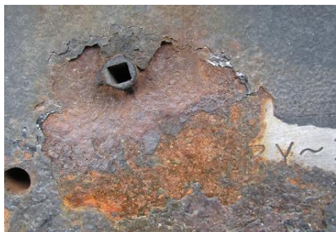
腐食し識別困難となった車台番号
