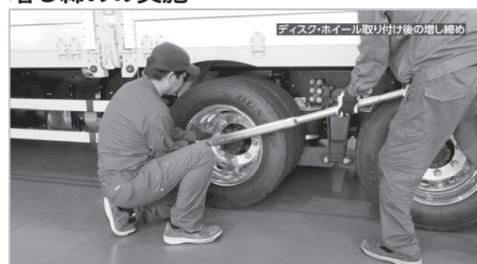
タイヤ脱着後、50km～100km 走行後を目安に、ホイール・ナットを既定のトルクで再度締め付けます
