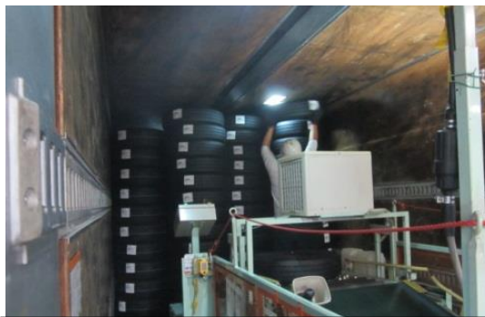
先端部分も上下左右に可動し 上部への積み込みも容易
