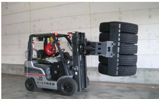
クランプリフトで荷台に積み付け
