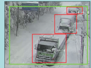
AIによる自動検知のイメージ(滞留車両の発生)
