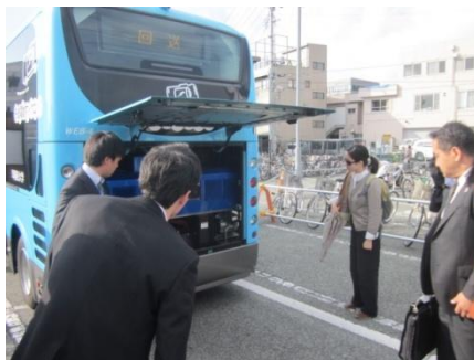
電動バス後部のバッテリー
