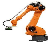
ピッキングロボット
