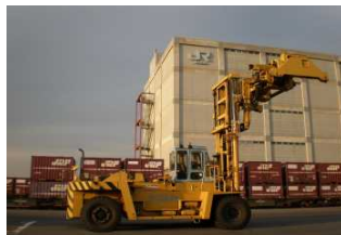
トップリフターによる作業 (JR貨物提供)
