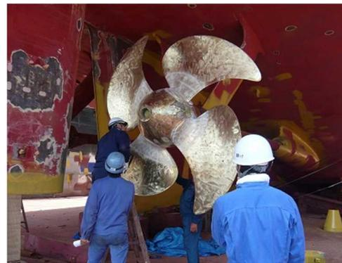
可変ピッチプロペラの検査の様子
