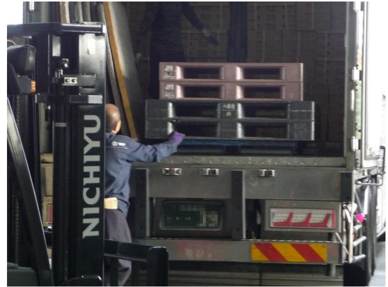
T11型パレットをドライバーが荷室に敷設
