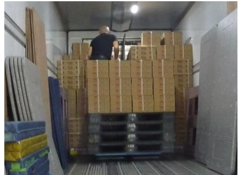
敷設したT11型パレットに構内用パレットからドライバーが積み替え
