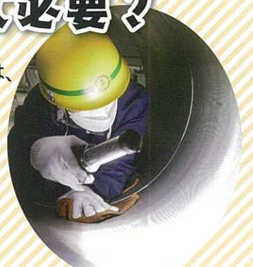
東亜工機(株) 横田製造部 技能職員 大賤さん 【仕事内容】 船舶エンジンの主要部品「シリンダライナ」の製造、点検
