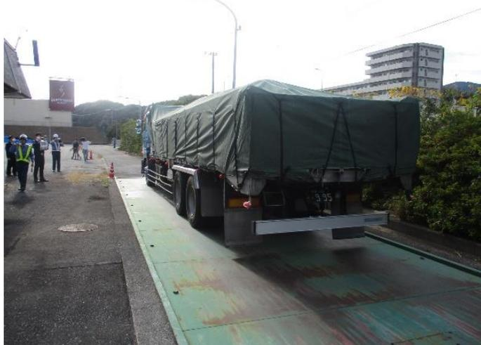
重量計にて過積載運行か否か計測
