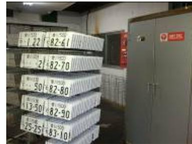
ガス釜でスタッカーに乗せたプレートを焼き付けて完成
