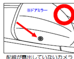
配線が露出していないカメラ
