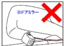
カメラの配線露出
