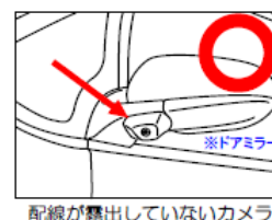
配線が露出していないカメラ
