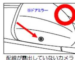
配線が露出していないカメラ
