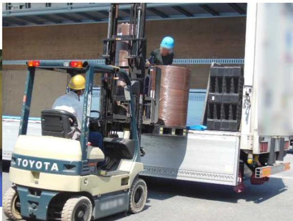
倉庫に横積み保管されている製品を、ラムフォークリフトで1本ずつトラックの荷台に積み付ける。製品によっては、パレット積みで保管されているものもあり、パレットのままフォークリフトで荷台の高さまで上げた後、ドライバーが斜めに転がしながら荷台奥へと移動させていく作業が発生。
