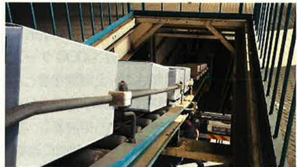
コンベア式のソーターで トラックの荷台へ搬送されるみかん
