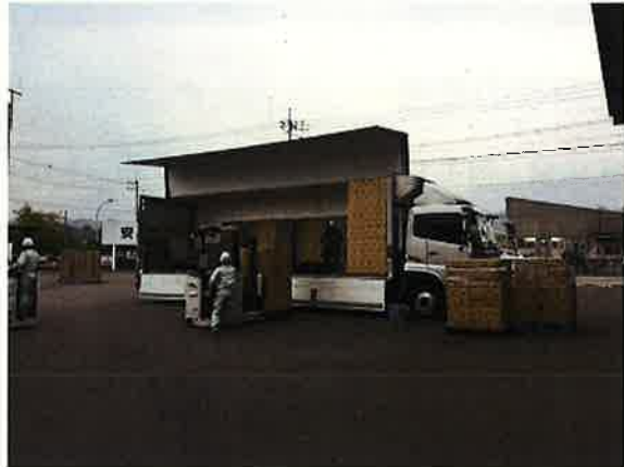
関東方面車両の積込の様子 パレットから崩し、荷台へバラ積みを行う
