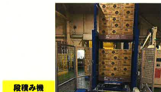
図 グループ会社におけるキューブ型輸送導入に対応したラップ巻き機と段積み機の導入事例
