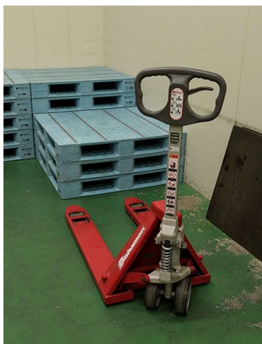
今回使用した 荷役機材。 工場専用 パレットと ハンドフォーク
