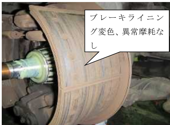
写真3 右前輪ブレーキライニング
