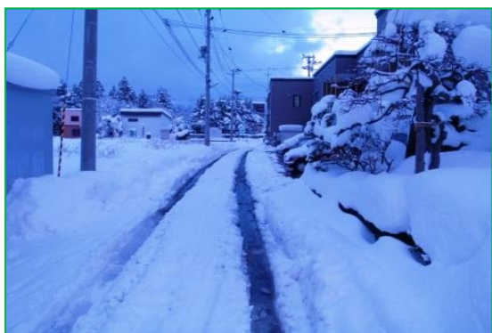
両輪で圧雪された路面が轍となり、車体底部と中央の積雪部とが接触する。
