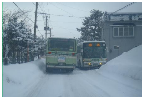
除雪に伴い路端に堆積した雪により、道幅が狭くなり、バスのすれ違いが困難。
