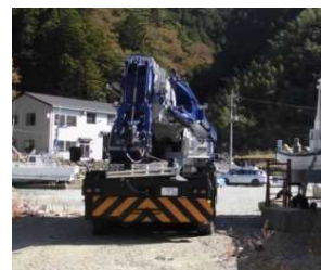
上架に使用するクレーン車
