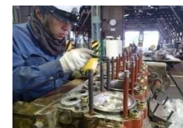
写真）エンジン分解検査
