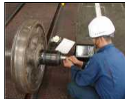
写真）車軸の超音波探傷検査
