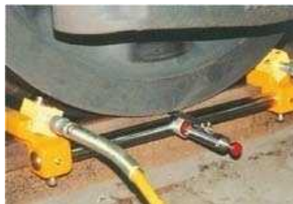
写真）輪重測定器
