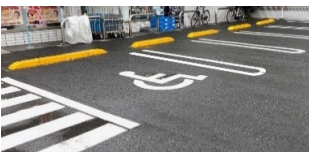
狭小敷地等での車椅子使用者用駐車施設の確保・ダブルライン活用による駐車場全体の緩やかなバリアフリー化のイメージ
