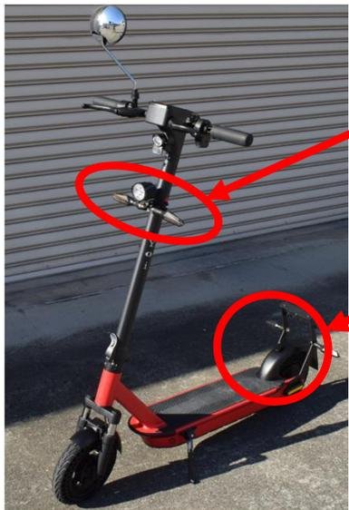
・前方の左右方向指示器の最内縁の間隔が基準値（24cm以上）を下回る。
