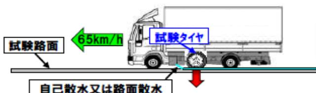
専用のタイヤ試験車に試験タイヤを装着し、制動力を加えた際の最大制動力係数  $\mu$  (=摩擦特性) を測定。
