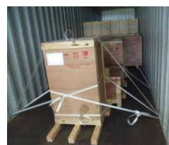
図 30 コードストラップを使用した固定 (例)
