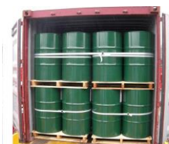
図 30 コードストラップを使用した固定 (例)
