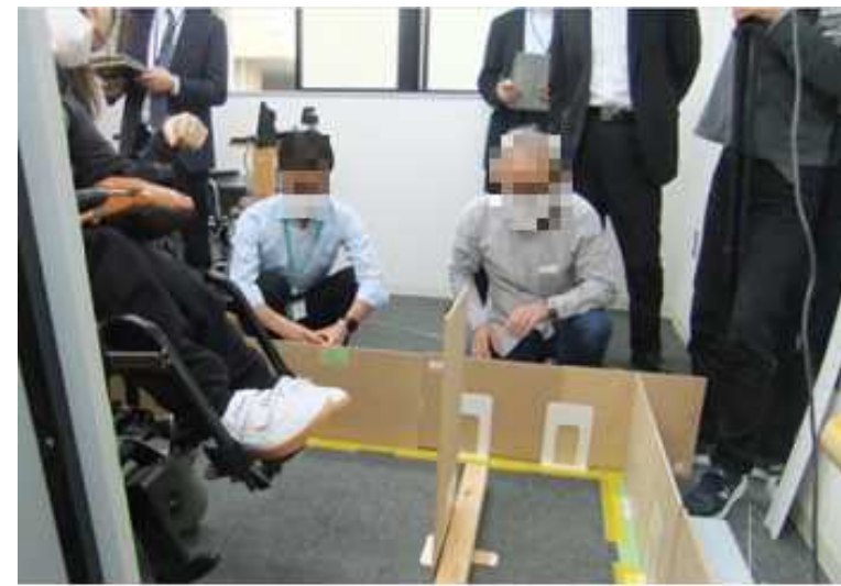
袖部50cm（入口幅90cm）、奥行135cm＝現行三宮EVに合わせ検証
