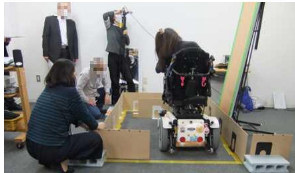
袖部を20cm、10cm、0cmと調節し入口幅を変化させEV内への入りやすさを検証
