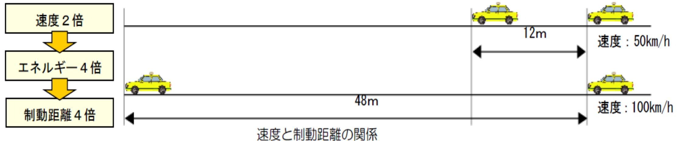
車の停止には、ブレーキを踏み込む間(空走距離)とブレーキが効くまでの間(制動距離)を足した距離が必要であり、速度を上げれば停止距離は速度の2乗に比例して長くなることを理解させましょう。
