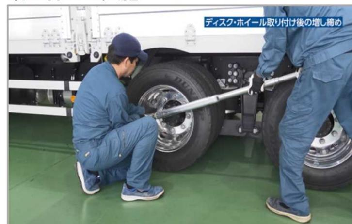
タイヤ脱着後、50km~100km 走行後を目安に、ホイール・ナットを既定のトルクで再度締め付けます
