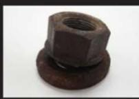
ホイールナットに生じた錆や付着したゴミ等により、ワッシャーの振動部が歪曲している。      ホイールナットとワッシャーに変形が見られ、ワッシャーがはずれかかっている。
