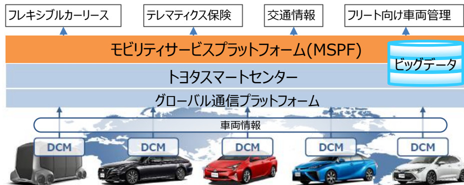
※DCM (Data Communication Module) 車載専用通信モジュール
