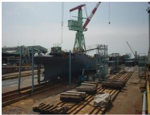
ブロック建造は、現在の造船手法の主流です。この方法は1950年代始めに導入された建造法で、地上の作業場であらかじめ部材を組み立てた船体のかたまり（ブロック）を造り、これを大型クレーンで船台に運んで接合して組み立てる方法です。
