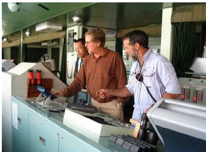
ブリッジ(操舵室)において、操船設備、無線設備、海図等の検査をします。写真は船舶自動識別装置の作動、操作を検査しています。
