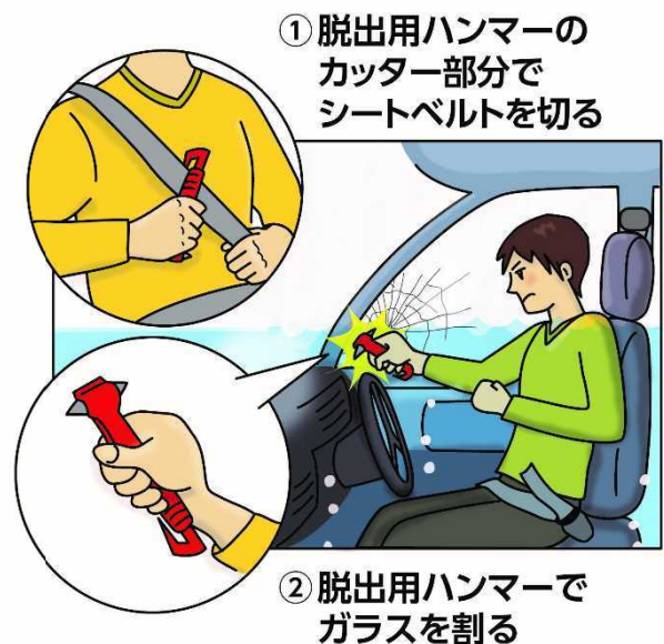
脱出用ハンマー、シートベルトカッターの使い方 (JAF ホームページより)
