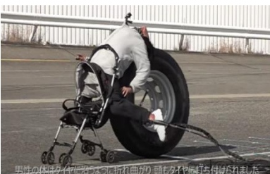
ダミー人形に大型車から脱落したタイヤが衝突する模擬実験の様子
