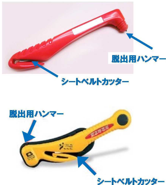
脱出用ハンマー、シートベルトカッターの例
