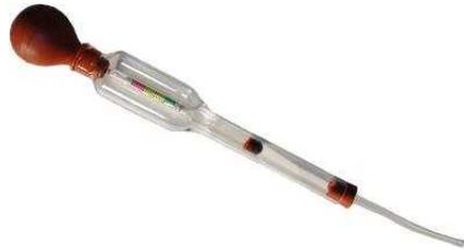
蓄電池の電解液の比重測定用のもので、電解液吸出し用のスポイトの中に比重計が入っているもの。このスポイトは対象とする自動車の蓄電池電解液の容量に応じたものであること。
