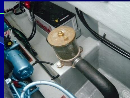
海水濾し器点検 キングストーンコックを開ける
