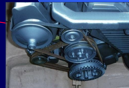
ベルト類点検 回転部分周囲の確認
