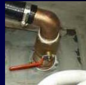
海水濾し器点検 キングストーンコックを開ける
